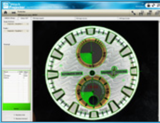
Superposition DXF et contrôle dimensionnel en simultané avec image couleur en option
